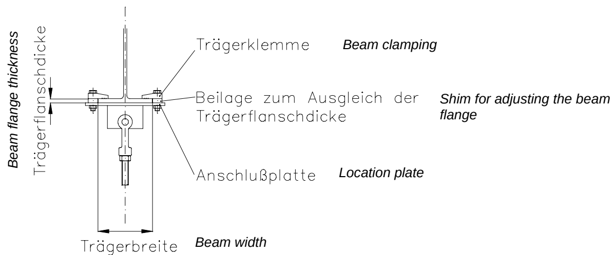
Abb. 5 : Trägerklemmbefestigung mit erforderlichen Abmessungen und Bauteilen
